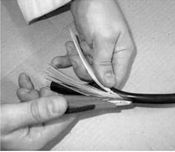
En el caso de la fibra final y lateral (EMS y LMS), cortar con precaución la funda protectora con cuidado de no dañar la fibra a una distancia de 15cm aproximadamente.
