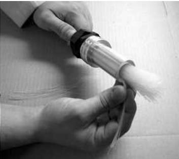
Rellenar el conector con trozos de fibra sobrantes hasta conseguir el compactado de las mismas.
