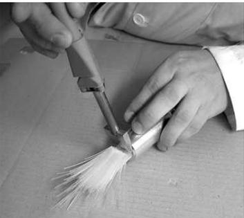
Cortar con soldador de corte en la posición que indica la fotografía, quedando así el mazo acabado.
